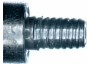
ПОВРЕЖДЕННЫЙ → Типовые ультразвуковые инструменты перегружают сонотрод и резко сокращают срок его службы
